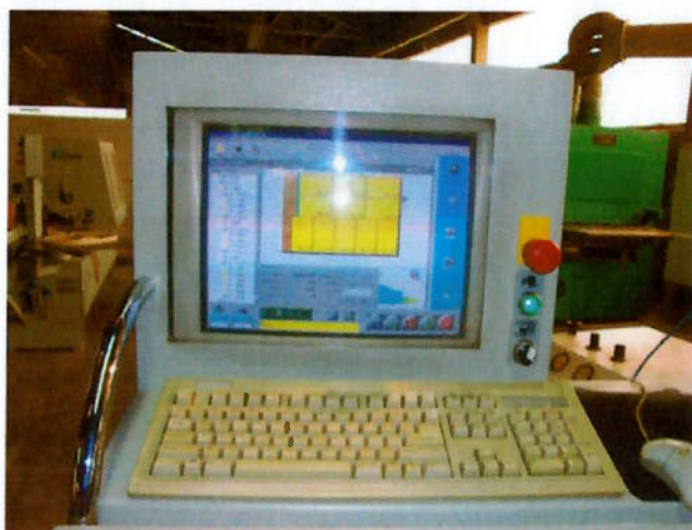
Figura 6 - Computador da Seccionadora Automática
